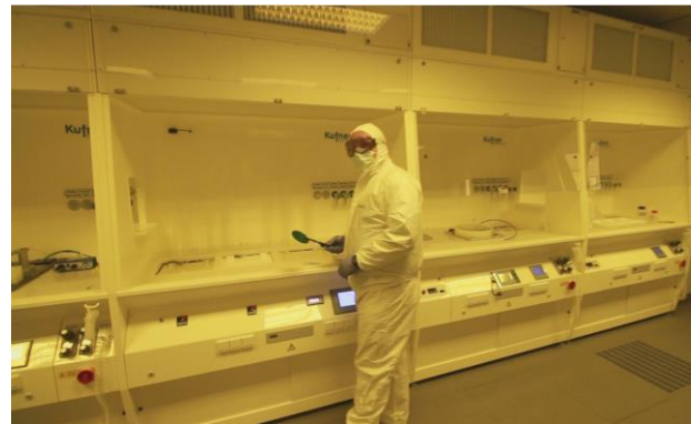
Arbeiten an der Nassprozessstrecke
